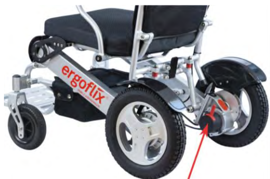
Illustration 14 : emplacement des freins électromagnétiques
